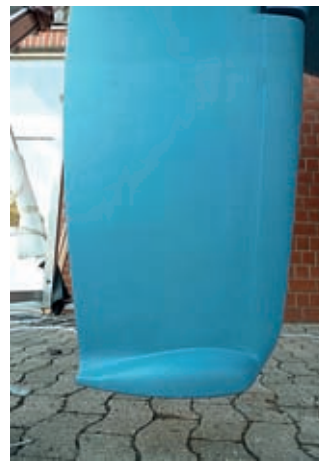
Moderne Twin-Kiele folgen den Prinzipien eines modernen Kurzkiels, bieten dazu aber im Watt (oder auch im Winterlager) noch einen sicheren Stand, der aber nicht nur auf zwei Beinen, sondern mit der zusätzlichen Standfläche im Ruder auf drei Beinen fußt. Fotos: Sirius-Werft
