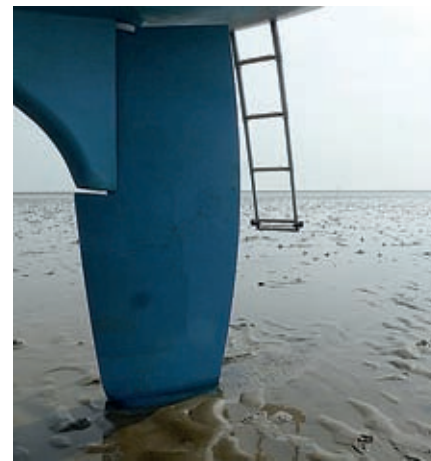
Moderne Twin-Kiele folgen den Prinzipien eines modernen Kurzkiels, bieten dazu aber im Watt (oder auch im Winterlager) noch einen sicheren Stand, der aber nicht nur auf zwei Beinen, sondern mit der zusätzlichen Standfläche im Ruder auf drei Beinen fußt. Fotos: Sirius-Werft
