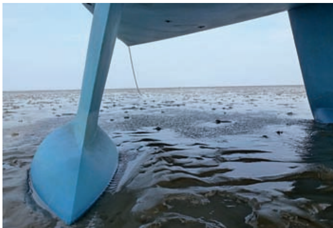
Moderne Twin-Kiele folgen den Prinzipien eines modernen Kurzkiels, bieten dazu aber im Watt (oder auch im Winterlager) noch einen sicheren Stand, der aber nicht nur auf zwei Beinen, sondern mit der zusätzlichen Standfläche im Ruder auf drei Beinen fußt. Fotos: Sirius-Werft
