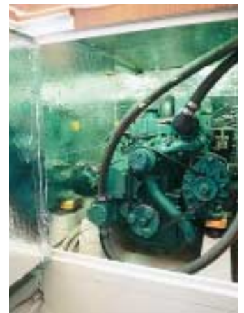
Für Laufruhe: Der Volvo 2030 mit Saildrive ist gut isoliert
