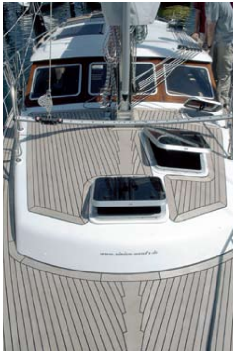
Lauf- und Oberdeck sind mit einem sauber verlegten Teakbelag versehen – sämtliche Fallen und Strecker werden auf eine Fallenstopperbank vor der zentralen Arbeitswinde umgelenkt und lassen sich aus dem Cockpit bedienen. Auch der Schlitten für die Selbstwendefock ist Standard
