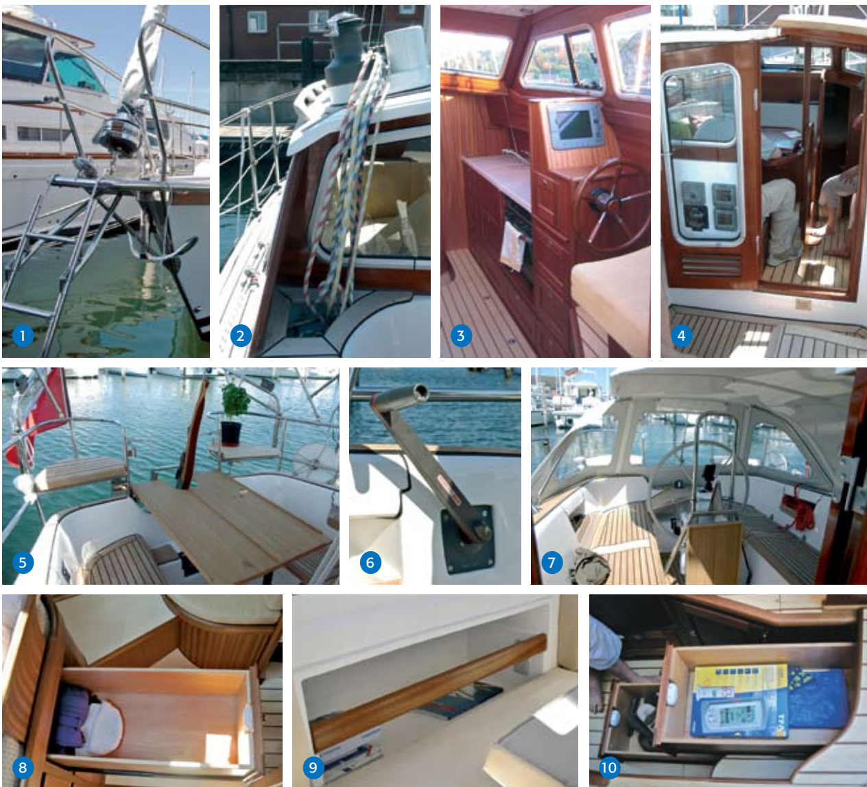
Kleine Auswahl der vielen bemerkenswerten Detaillösungen an und unter Deck: 1.: Bugspriet mit Trittstufe, Genua-Rollanlage am Kutterstag (optional), Leiter und Ankerführung unter Deck, 2.: Fallenkasten unter der zentralen Arbeitswisch auf dem Kajütdach, 3.: Innensteuerstand mit Instrumentenkonsolle, 4.: Niedergang mit fester Tür, 5.: aufklappbarer Cockpittisch und Heckkorbsitze (optional) in der Version mit Pinne, 6.: Winschkurbel als Hebel für die Maschinensteuerung, 7.: optionales Cockpitzelt bei einer Version mit Radsteuerung (die praktischen Schwalbennester sind Standard), 8., 9. und 10.: ebenso durchdachte wie umfassende Stauraumausnutzung im gesamten Schiff – ob unter den Trittstufen, hinter Sitzlehnen oder unter der Kojе
