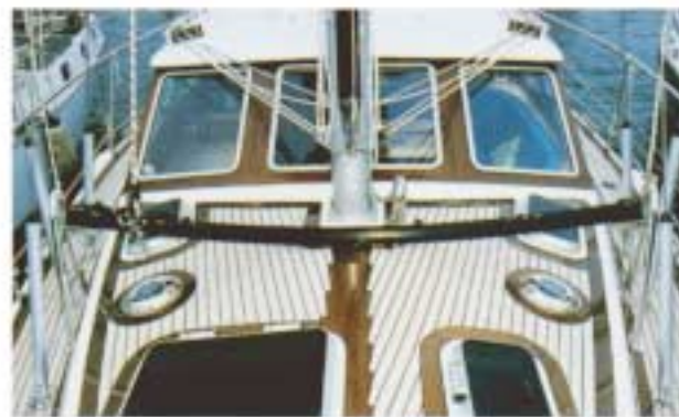
Leichtes Wenden: Kugellagerschiene für Selbstwende-Fock
