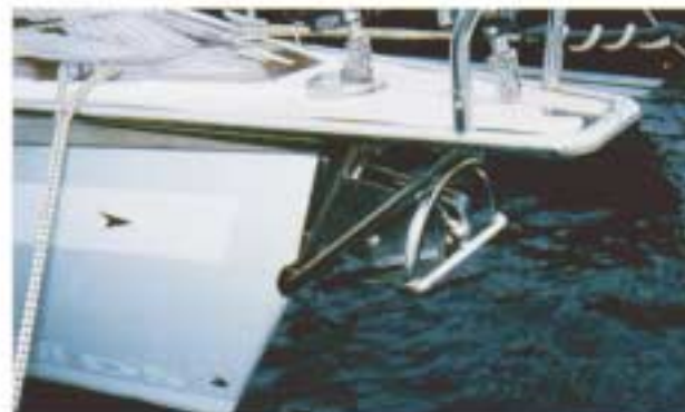
Besser Anker: integrierter Bügelanker und Elektro-Winch
