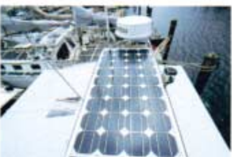
Viel Platz: Der Bügel nimmt Solarzellen, das Hecklicht und die Radarantenne auf
