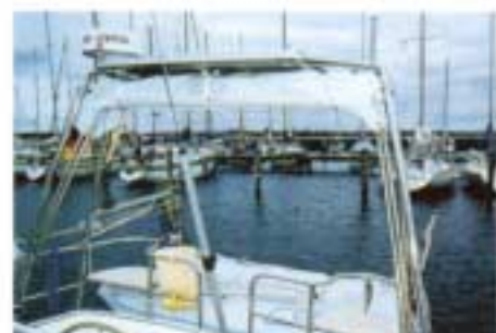
Hoch montiert: Unter dem Edelstahlbügel versteckt sich das Bimini-Verdeck
